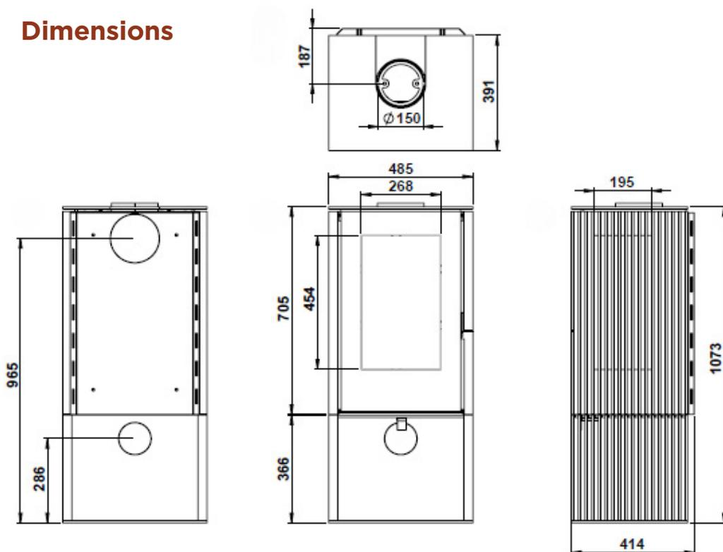
■ Raccordement au conduit de fumées possible par le dessus ou par l'arrière de l'appareil.
