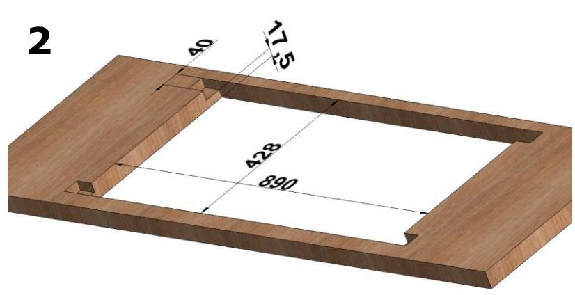
Découper le plafond et l'ajustement des encoches pour les pattes si elles sont utilisées
