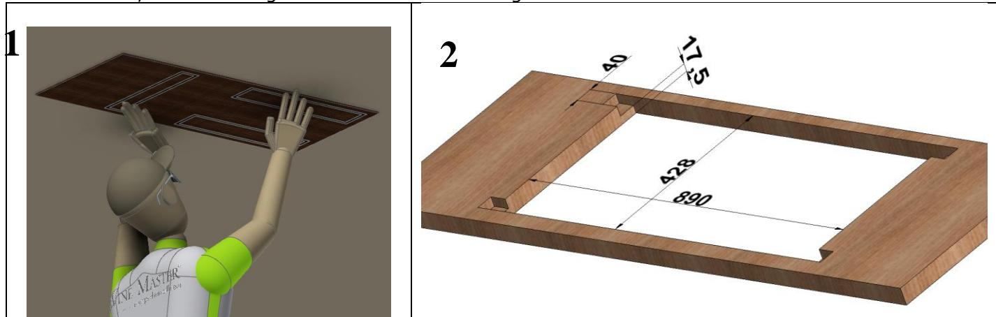
Verfolgen Sie anhand der Schablone den Standort der Klimaanlage (achten Sie darauf, dass nichts den Zugang zur Filterklappe verhindert)
