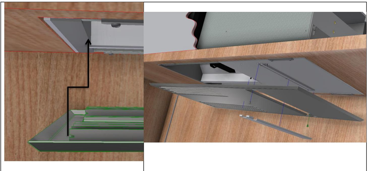
Le Capot est inséré sur la gauche au niveau des encoches puis vissé. Le cache est magnétique
