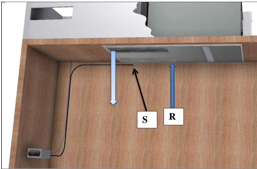
Der Thermostat kann im Schrank oder an der Vorderseite oder außerhalb des Schranks platziert werden. Seine Sonde (S) muss in Richtung der Rückluftzone (R) gerichtet sein. Es ist ratsam, darauf zu achten, dass die Spitze der Sonde das Schott nicht berührt und sich im Luftstrom befindet.
