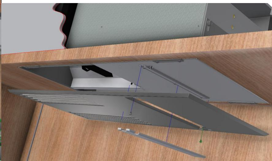
Der Deckel wird links an den Kerben eingesteckt und dann verschraubt. Die Abdeckung ist magnetisch.
