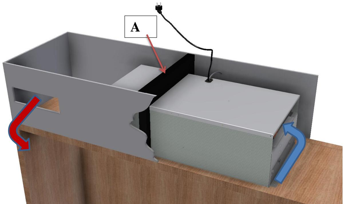
Trennen Sie die Luftströme. Der freie Durchgangsquerschnitt jedes Gitters beträgt  $200 \text{ cm}^2$ . Eine Trennung A ist nicht bereitgestellt. **Achten Sie darauf, dass diese Trennung dicht ist.**
