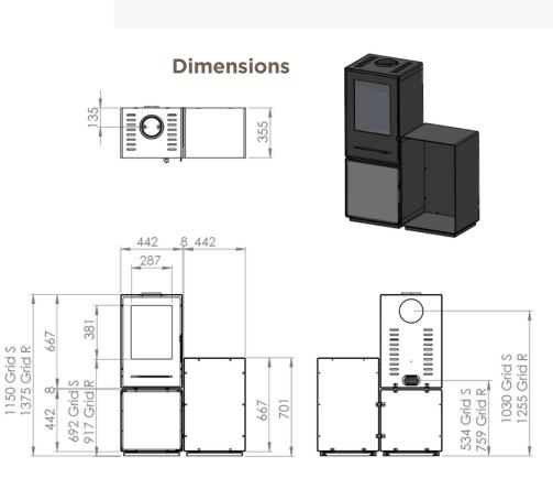
■ Raccordement au conduit de fumées possible par le dessus ou par l'arrière de l'appareil.
